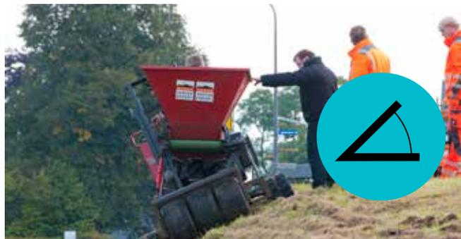
**Böschungspflanzer:** Diese Maschine kann an einem Gefälle mit einem maximalen Neigungswinkel von 30 bis 35 Grad pflanzen. Sie ist mit Raupenkettensystemen und einer zusätzlichen Pflanzschute für ein gleichmäßiges Pflanzergebnis versehen.
