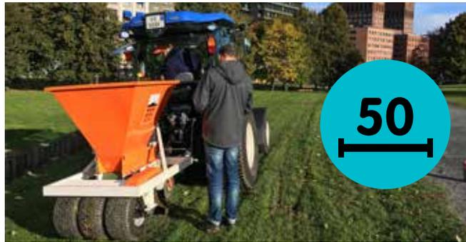
**Pflanzmaschine 50 cm:** pflanzt die Blumenzwiebeln in einer Breite von einem halben Meter. Geeignet für Seitenstreifen, wo die Arbeitsbreite im Gras schmaler als ein Meter ist. Oder wenn Sie lange Bahnen schaffen möchten, aber weniger Budget haben.
