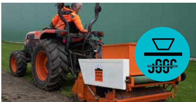
**Roto-Pflanzer:** Diese Maschine pflanzt in einer Breite von einem Meter und kann in einem einzigen Arbeitsgang fräsen, pflanzen und walzen. Vor allem geeignet für weniger schwere Bodenarten. Für im Frühjahr und im Sommer blühende Blumenzwiebeln zu verwenden.
