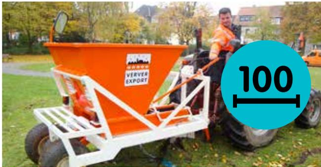
**Pflanzmaschine 100 cm:** pflanzt die Blumenzwiebeln in einer Breite von einem Meter. Geeignet für Bahnen in Seitenstreifen und Parks oder das Bepflanzen von Flächen.
