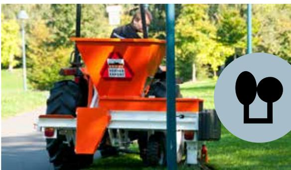
**City Planter:** pflanzt die Blumenzwiebeln mit einer Breite von 50 cm. Bei dieser Maschine befindet sich die Pflanzschute neben der Maschine. Geeignet für Standorte, an denen Sie gerne von Baum zu Baum, von Pfahl zu Pfahl oder von Bank zu Bank pflanzen wollen.
