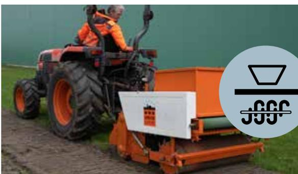
**Roto-Pflanzer:** Diese Maschine pflanzt in einer Breite von einem Meter und kann in einem einzigen Arbeitsgang fräsen, pflanzen und walzen. Vor allem geeignet für weniger schwere Bodenarten. Für im Frühjahr und im Sommer blühende Blumenzwiebeln zu verwenden.
