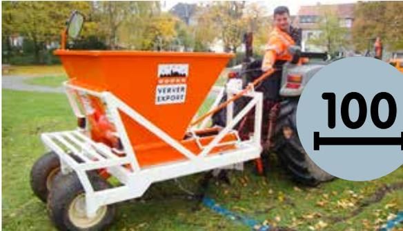
**Pflanzmaschine 100 cm:** pflanzt die Blumenzwiebeln in einer Breite von einem Meter. Geeignet für Bahnen in Seitenstreifen und Parks oder das Bepflanzen von Flächen.
