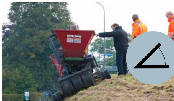
**Böschungspflanzer:** Diese Maschine kann an einem Gefälle mit einem maximalen Neigungswinkel von 30 bis 35 Grad pflanzen. Sie ist mit Raupenkettens und einer zusätzlichen Pflanzschute für ein gleichmäßiges Pflanzergebnis versehen.
