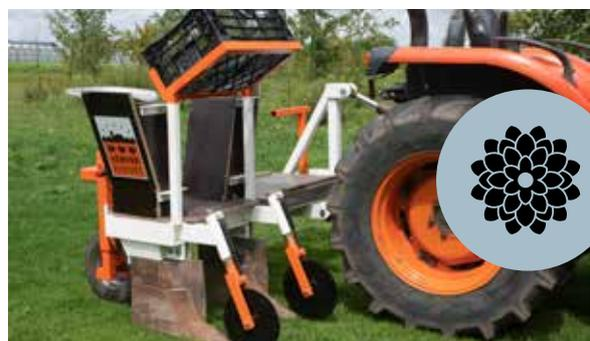
**Dahlienpflanzer:** ein doppelter City Planter, wobei die Knollen in 2 Reihen manuell in Trichter geworfen und gepflanzt werden. Es hängt keine Walze oder anderes Egalisierungsgerät hinter der Maschine, da der Boden locker bleiben muss. Unter Gras nicht möglich, der Boden muss zunächst gefräst werden.
